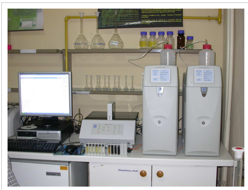
Fot. 3. Chromatograf jonowy firmy Dionex model ICS-1000 wykorzystywany do oznaczeń chemicznych próbek wody (fot. A. Skowron).
