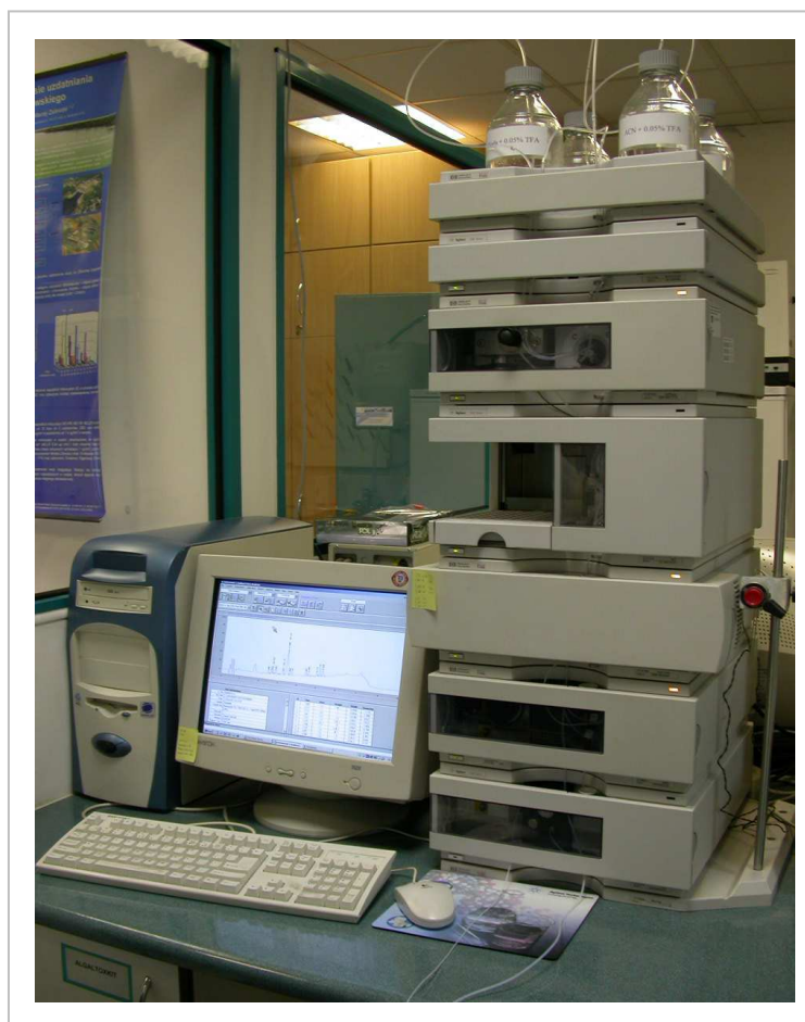
Fot. 4. Chromatograf cieczowy firmy Agilent Technologies model 1100 wykorzystywany do oznaczeń mikrocysty (toksyn sinicowych) (fot. T. Jurczak).
